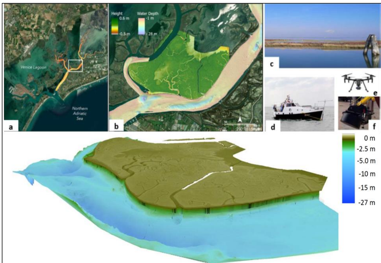
Figura 1. (a) Area di studio nella Laguna Nord con in arancione l'area mappata con il MBES; (b) dati di quota della barena S. Felice e di batimetria del Canale S. Felice acquisiti nel 2021; (c) foto della barena S. Felice; (d) imbarcazione Litus del CNR-ISMAR con la strumentazione MBES utilizzata per i rilievi batimetrici nella laguna; (e) drone aereo DJI SPARK on sensore ottico 1/2.3" e lente 25 mm f/2.6, utilizzato per acquisire le foto aeree e creare il modello digitale della barena; (f) ecoscandaglio a multifascio Kongsberg EM2040C (MBES) usato per acquisire i dati batimetrici dei canali analizzati; (g) Visualizzazione 3D della cartografia integrata del sistema barena-canale di S. Felice.
